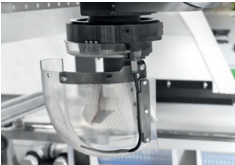
Deflettore (convogliatore di trucioli) gestito da controllo numerico.
